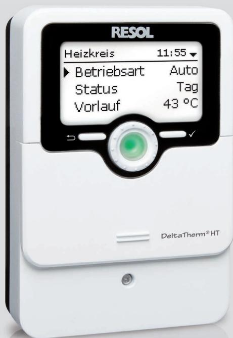
Der DeltaTherm® HT bietet eine kompakte, bedienerfreundliche Lösung für einfache Heizsysteme und übernimmt die witterungsgeführte Regelung mit Raumeinfluss oder bedarfsgeführte Raumregelung mit 1 Raumtemperatursensor. Bei Verwendung einer zentralen Außensensoreinheit können mehrere Regler problemlos auf den Außentemperaturwert zugreifen – somit ist die Installation nur eines Außentemperatursensors notwendig. Zusätzlich verfügt der Regler über 5 verschiedene Betriebsarten und eine Nachtabsenkung.
